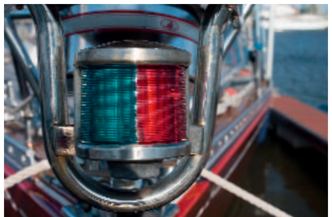
Positionslicht am Bug eines Segelbootes
